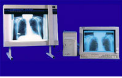
Abb. 3: Thorax Scanner inkl. Leuchtkasten, Auflösung 570*570 (Fa. D.L.B. Mainz)
