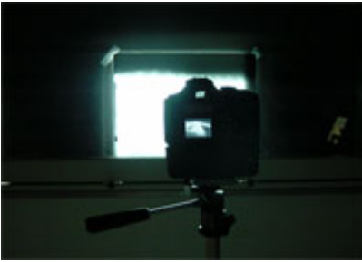
Abb. 6: Fotografieren vom Leuchtschirm; optimale Ergebnisse bei abgedunkelter Umgebung.
