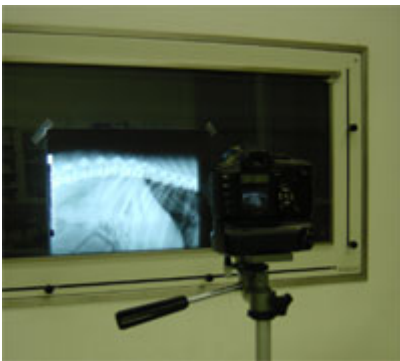
Abb. 5: Röntgenbild Digitalisierung mit einer Spiegelreflexkamera
